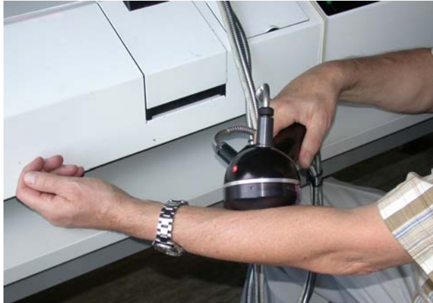
Spektralphotometer 554 der Firma Perkin-Elmer, Überlingen, Bodensee (190 – 900 nm, \Delta\lambda < 0,5 - 4 \text{ nm} )
